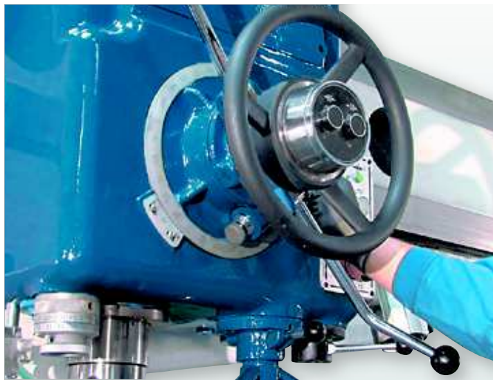
Mélységi ütköző nőniusszal
